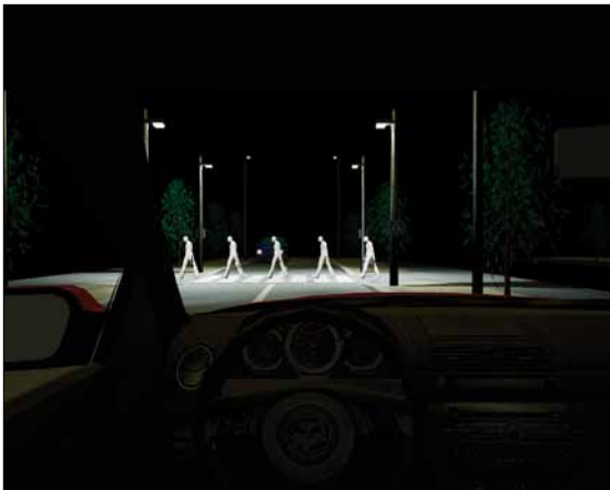
Obr. 5. Přechod typu A/čtyři svítidla (S2) – VYHOVUJE
