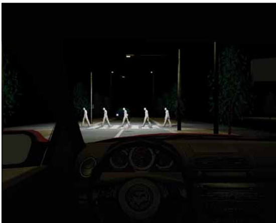
Obr. 4. Přechod typu A/dvě svítidla (S3) – VYHOVUJE
