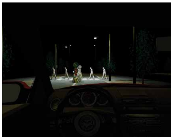
Obr. 6. Přechod typu B/dvě svítidla (S9) – VYHOVUJE
