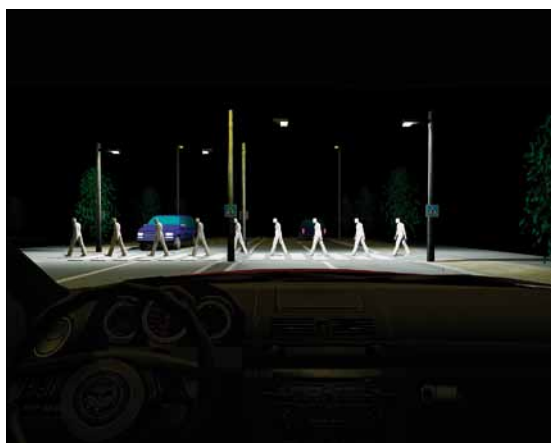
Obr. 8. Přechod typu C(D)/čtyři svítidla (S2) – VYHOVUJE
