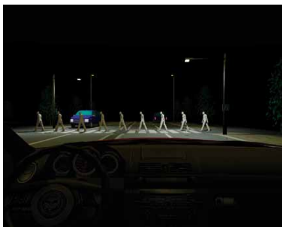
Obr. 7. Přechod typu C(D)/dvě svítidla (S4) – NEVYHOVUJE
