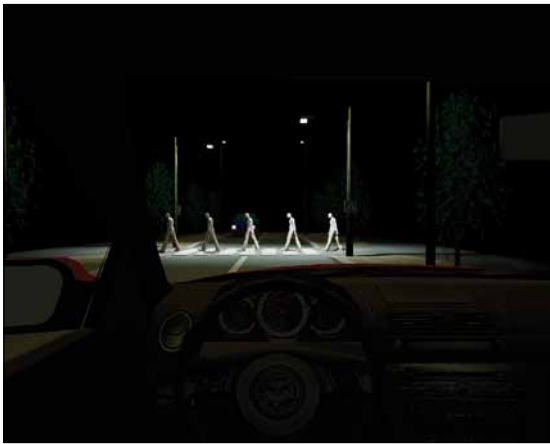
Obr. 3. Prostorová vizualizace osvětlenosti chodce na přechodu typu A/dvě svítidla (S1) – NEVYHOVUJE (chodci v levé polovině přechodu splývají s pozadím)
