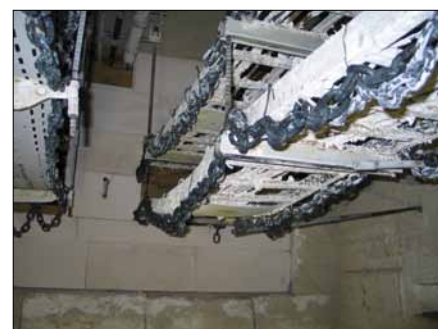
Obr. 3. Po zkoušce požární odolnosti kabelového nosného systému
