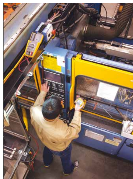
Obr. 2. Umístění multimetru na místo měření (vlevo nahoře na stroji)
