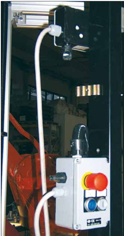
Obr. 3. Adaptér Tina 2A se závitem M20 se snadno instaluje a umožňuje kompatibilitu libovolného mechanického spínače nebo tlačítka s elektronickým bezpečnostním modulem Vital
