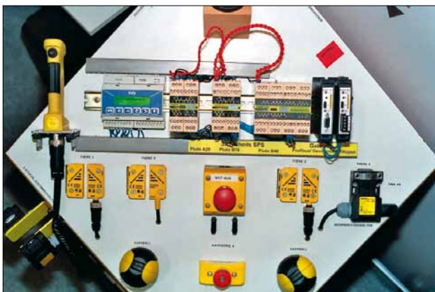
Obr. 2. Na bezpečnostní programovatelný automat Pluto nebo na bezpečnostní modul Vital je možné napojit několik dynamických senzorů Eden i adaptérů Tina
