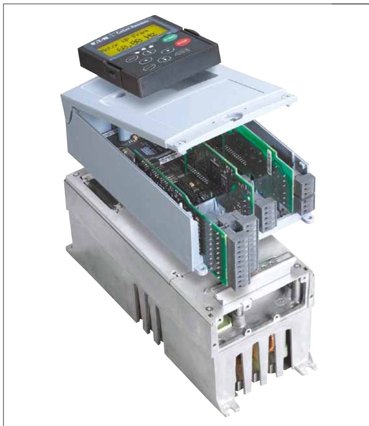
Obr. 3. Modulární konstrukce měničů frekvence SVX
