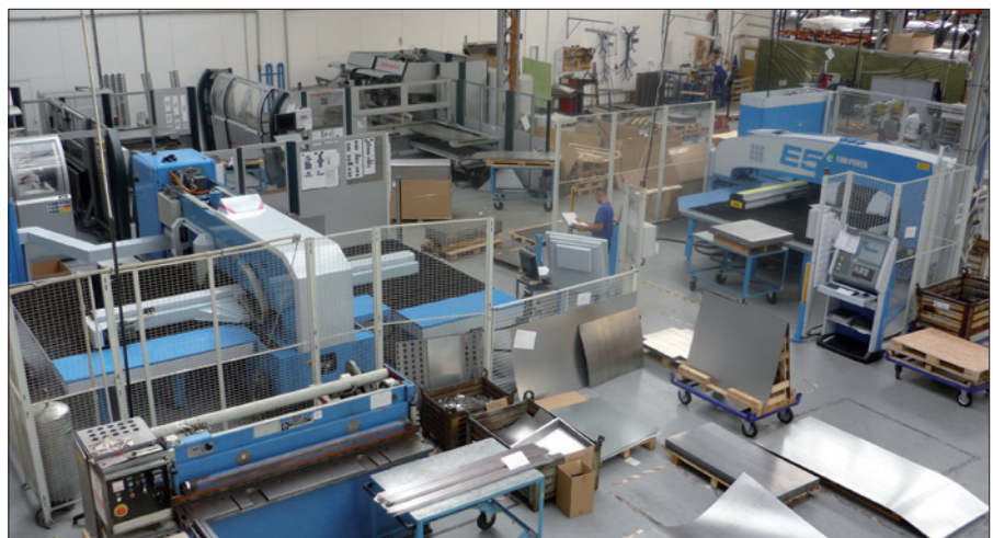
Obr. 6. Děrovací stroj Finn-power II
