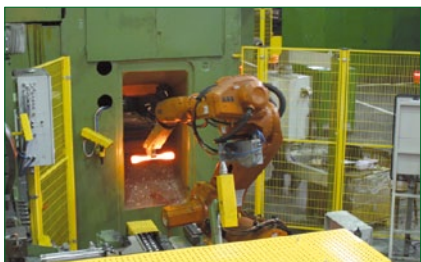
Obr. 1. Robot ABB IRB 6640 podává kovací zápusťek rozžhavený na asi 1 250 °C kovacímu stroji
