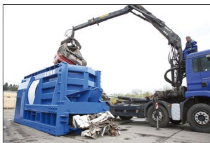
Obr. 2. Hydraulické nůžky na šrot - CNS 700
