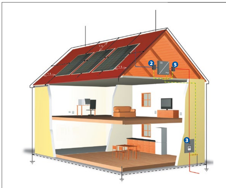
Obr. 4. Řešení při nedodržení dostatečné přeskokové vzdálenosti
