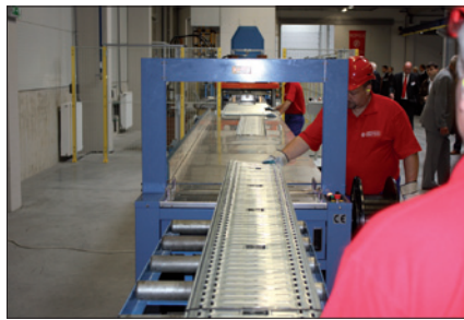
Obr. 3. Lisovací linka DIMECO na kabelové nosné systémy – žlaby a lávky – Jupiter a Mars
