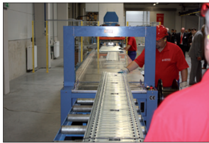
Obr. 3. Lisovací linka DIMECO na kabelové nosné systémy – žlaby a lávky – Jupiter a Mars
