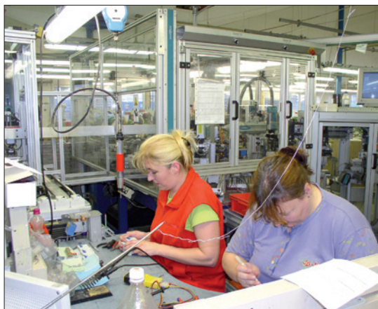
Obr. 2. Kompletace proudových chráničů ve výrobním závodě Moeller v Suchdole
