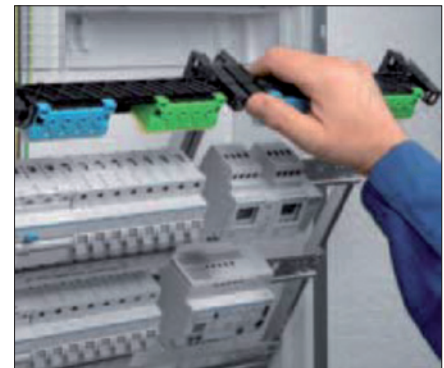
Obr. 5. Přístrojový rošt lze ze skříně po odjištění nosných lišt snadno vyjmout a opět namontovat pouhým nasazením do skříně
