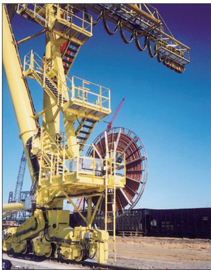
Obr. 1. Portálový jeřáb – aplikace motorového navíjecího bubny a kabelové vlečky
