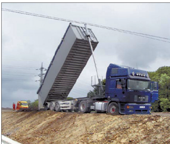
Obr. 1. Spojení hydraulického mechanismu sklápěčky návěsu s vedením vn [1]
