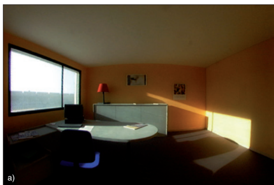
Obr. 3. Jas objektů na pracovišti a) pracoviště nestíněné – velké rozdíly mezi jasem vnímaných ploch v zorném poli, b) pracoviště po omezení nadbytečného jasu použitím stínicího systému
