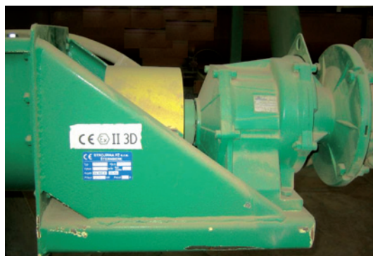
Obr. 21. Označení na konstrukci šnekového dopravníku určeného k provozu v prostředí s vnějším vlivem BE3N1 se zónou 2 (zdroj: Jiří Grepl, revizní technik elektro, Prostějov)
