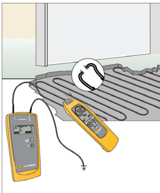
Obr. 7. Metoda dvou vysílačů při hledání přerušení topných kabelů v podlaze
