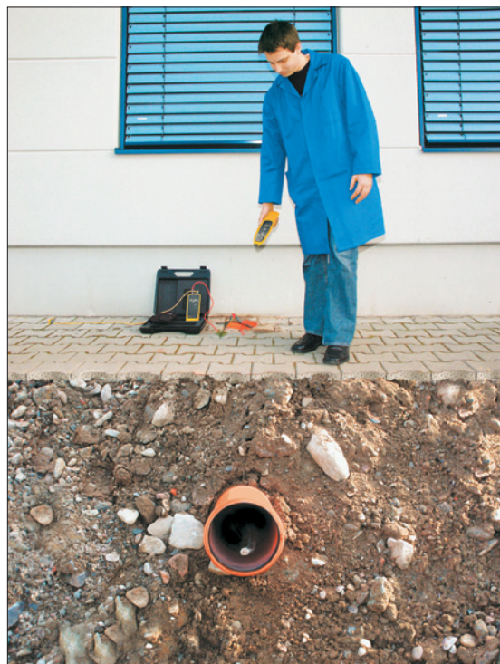
Obr. 8. Fluke 2042 zvládne hloubku až 2,5 m
