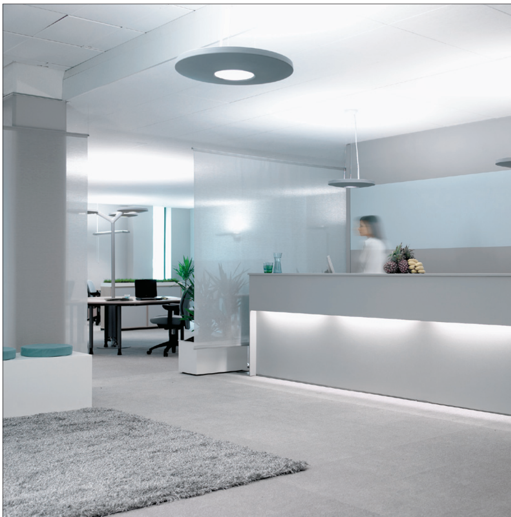
Obr. 7. „Rodina“ svietidiel Ten pozostáva z viacerých typov svietidiel s podobným dizajnom; v kanceláriách Nordica je použitý typ Ten Line Beta 2 \times 49 \text{ W} s matnou dvojitou parabolickou mriežkou a s priamo-nepriamym vyžarovaním
