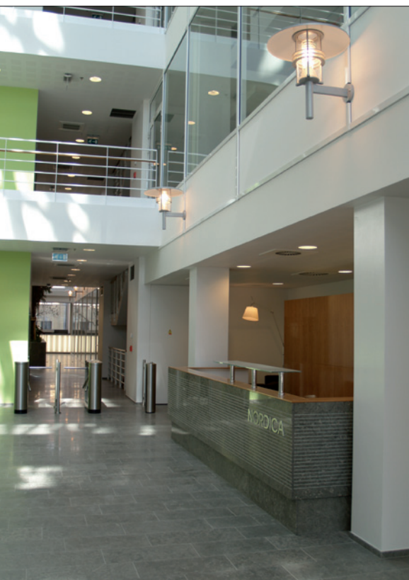
Obr. 1. Vstupná hala a recepcia sú osvetlené svietidlami typu Pleiad G2 2x 17 W s úspornou prevádzkou; na stenách svietidlo Wega Wall MT 70W
