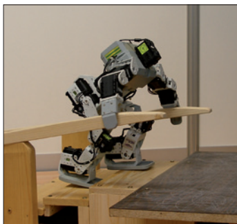
Obr. 11. Robotek v akci (dálkově řízený robot ze stavebnice Bioloid studenta SPŠSE Liberec Filipa Svobody stoupá po schodech, tančí podle hudby, reaguje na zvuk) - Přehlídka výukových robotů v expozici FCC Public
