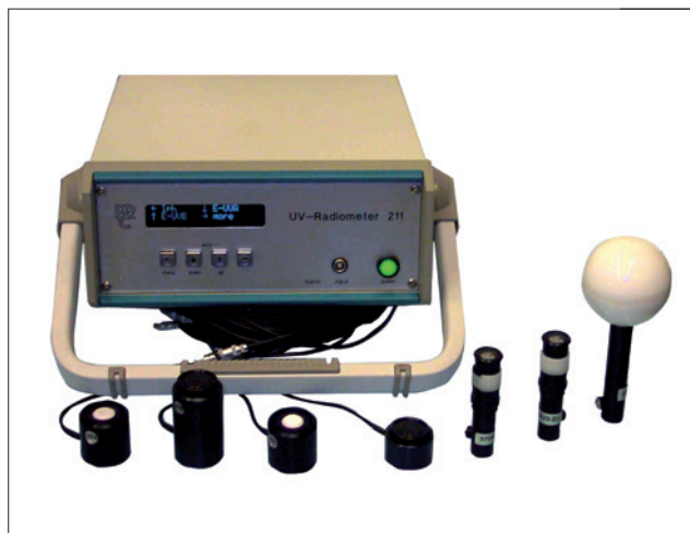
Obr. 4.6. Přesný digitální luxmetr a radiometr typu 211 firmy PRC Krochmann s čidly: zleva tři čidla pro měření ozářenosti v UV oblasti, uprostřed fotočlánek luxmetru pro měření osvětlenosti rovinné plochy (přijímací ploška s kosinusovým nastavením je chráněna krytem) a na pravé straně speciální nastavec s fotonkami pro měření střední poloválčové, válcové a kulové osvětlenosti
