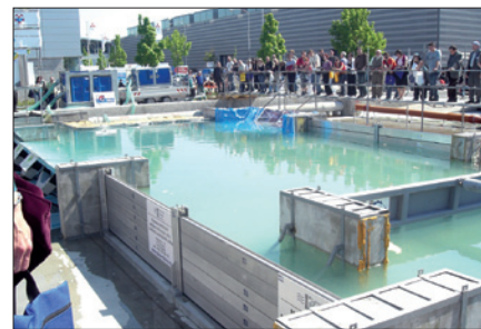
Obr. 2. Ukázka těsnících a normých stěn jako inspirace pro obce v záplavových územích
