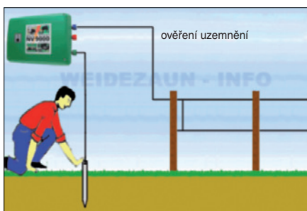
Obr. 4. Správné uzemnění – při dotyku rukou není nic cítit
