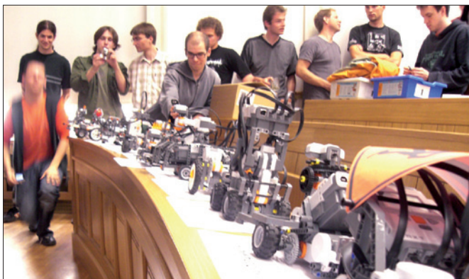
Obr. 2. Ukázky několika konstrukčních řešení mobilních robotů ze stavebnice LEGO Mindstorms NXT, které kromě pestré sady konstrukčních prvků obsahují i elektronické prvky – senzory, aktuátory a prvky regulace a řízení a hlavně mikroprocesor se vstupními a výstupními kanály.
