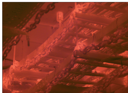
Obr. 2. Teplota během zkoušení kabelového nosného systému dosáhla až 1 006 °C
