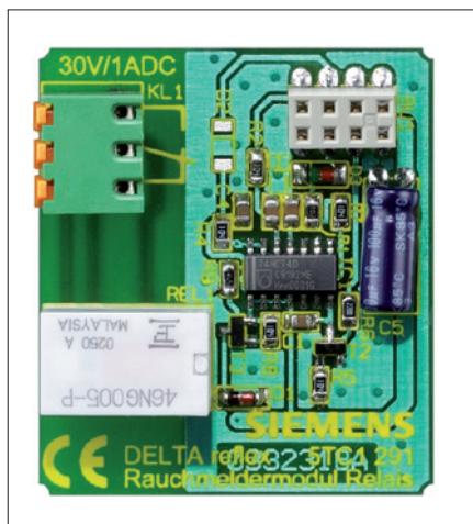
Obr. 3. Modul relé 5TC1 291, 1 přep. kontakt pro max. 1 A/30 V DC a 0,5 A/42 V AC
