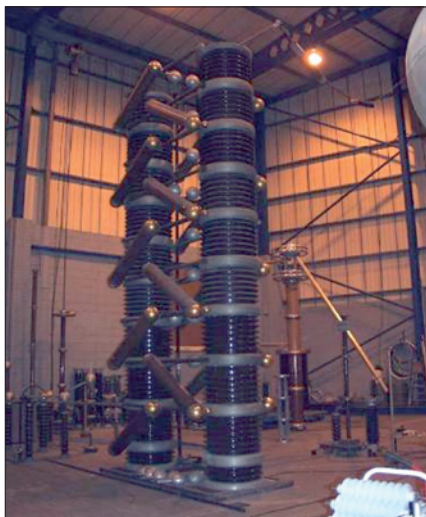
Obr. 1. Zkušební laboratoř vvn vývojového centra v Brightonu (VB), která je často využívána pro typové a vývojové zkoušky podle norem IEC a ANSI; maximální hodnoty rázového generátoru jsou 1,65 MV a 100 kA
