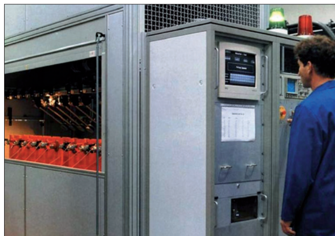
Obr. 8. Kusová zkouška omezovačů přepětí
