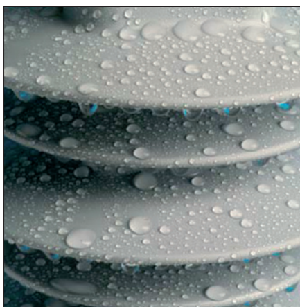
Obr. 7. Ukázka nesmáčivosti silikonového pláště
