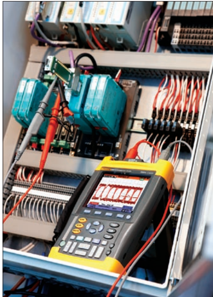
Obr. 2. Připojení osciloskopu na sběrnicu adaptérem BHT1890
