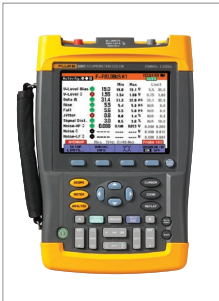
Obr. 1. Obrazovka přístroje Fluke 225 v režimu BusHealth
