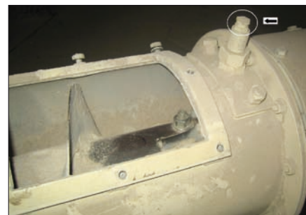
Obr. 4. Pohled na část šnekového dopravníku se zvýrazněním maznice
