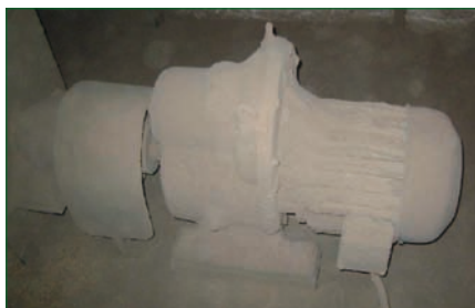
Obr. 3. Elektromotor ve spojení s převodovkou pohánějící šnekový dopravník
