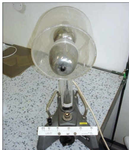
Obr. 1. Elektrostatický kilovoltmetr z univerzity v Plzni
