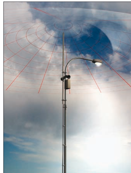
Obr. 3. Ochranný prostor kolem stožáru lampy
