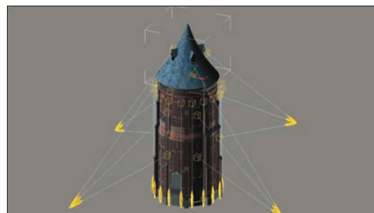
Obr. 5. Schéma rozmístění svítidel (objekt 2)
