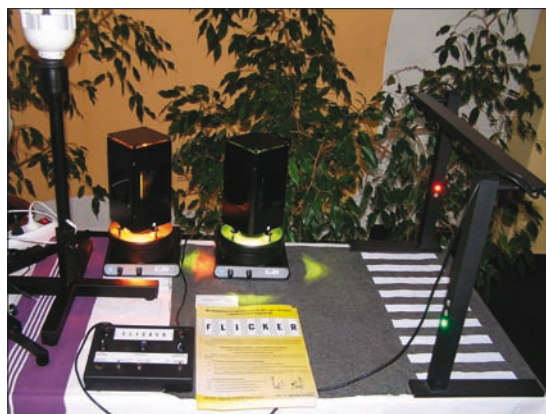
Obr. 1. Funkční model osvětlení přechodů světelnými diodami LED s dynamickým režimem v prezentaci slovenské společnosti SEAK
