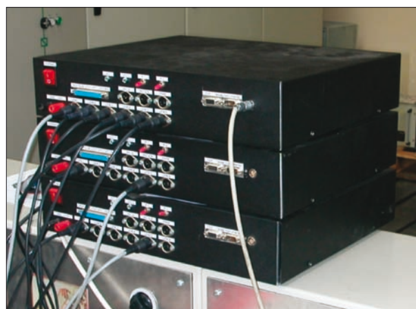
Obr. 5. Trojice systémů DSP při měření účinností komponent modelu hybridního pohonu
