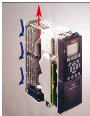
Obr. 1. U chlazení Cold Plate je elektronika měniče namontována na masivní blok chladicího tělesa a vzduch je veden přes speciálně tvarovanou žebra
