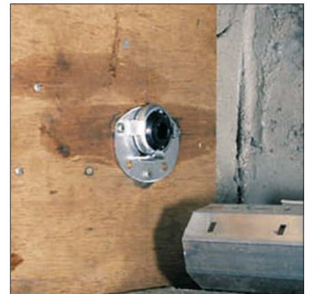
Obr. 4. Opěrné ložisko vyrovnat a namontovat
