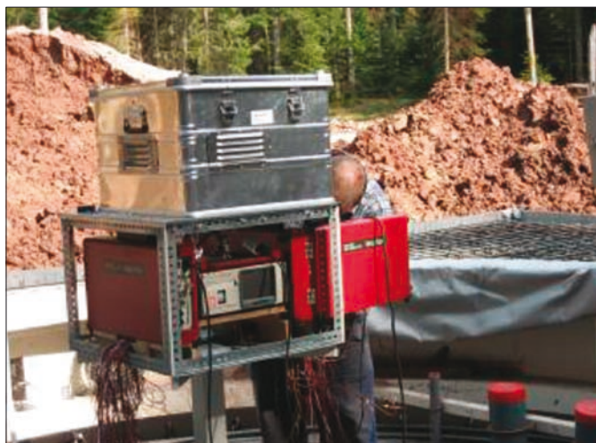
Obr. 4. Palivový článěk EFOY 600 ve venkovní skříni jako napájecí zdroj pro záznamník dat
