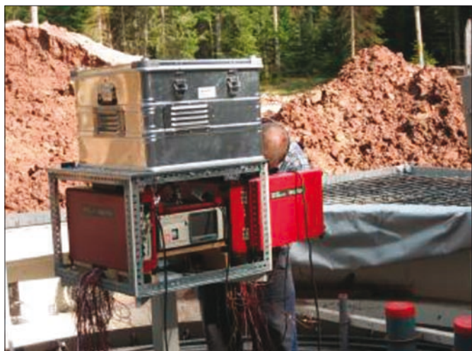
Obr. 4. Palivový článek EFOY 600 ve venkovní skříni jako napájecí zdroj pro záznamník dat
