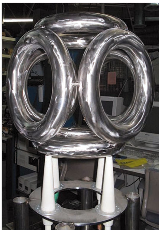
Obr. 2. Pohled na poslední verzi fúzního zařízení polywell WB-6 R. Bussarda
