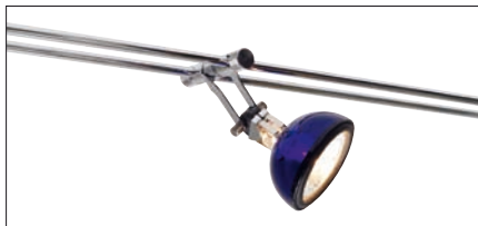
Obr. 4. Svítidlo Yps (do systému Clix) výrobce: německá firma Oligo obj. číslo: OL 9-60142 provedení: chrom světelný zdroj: halogenová žárovka 50 W, 12 V, GU5,3 rozměry: výška 100 mm, průměr 51 mm dekorativní modrý kryt k objednávce zvlášť dodáváno bez světelného zdroje cena včetně DPH: 1 634 Kč
