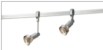
Obr. 3. Svítidlo Gate B Seven (do systému Check-In) výrobce: německá firma Oligo obj. číslo: OL 10-2019008 provedení: hliník světelný zdroj: halogenová žárovka 50 W, 230 V, GZ10 rozměry: výška 90 mm, průměr 51 mm dekorativní kroužek k objednávce zvlášť dodáváno bez světelného zdroje cena včetně DPH: 3 309 Kč
