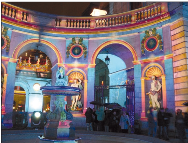
Obr. 1. Tradiční osvětlení nádvoří radnice Lyonu v roce 2006. Pro projekci byly použity projektor s pevnou hlavou skrze statické filmové pole o rozměrech 15,5 × × 15,5 cm
