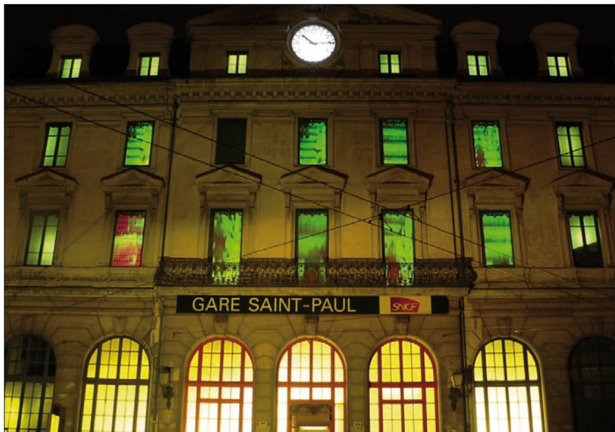
Obr. 5. Osvětlení fasády nádraží a projekce v oknech v roce 2007. Fasáda je osvětlena halogenidovými výbojkami s barevnými filtry. Pro projekci v oknech byla využita divadelní technika umožňující projekci filmu
