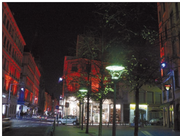
Obr. 8. Výzdoba ulic v roce 2006. Svítidla veřejného osvětlení jsou doplněna barevnými filtry, na fasádách jsou dočasně instalována svítidla s halogenovými výbojkami a barevnými filtry
