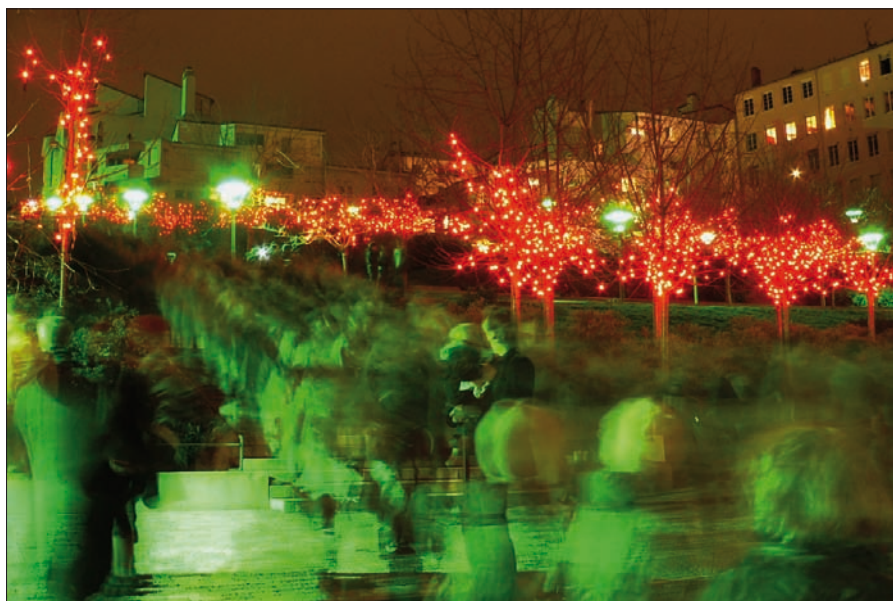
Obr. 2. Osvětlení parku v roce 2007. Využito je existující veřejné osvětlení s halogenidovými výbojkami dočasně doplněné barevnými filtry a žárovkovými girlandami
