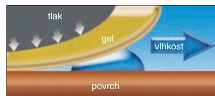
Obr. 2. PowerGel – vytěšňování vlhkosti
