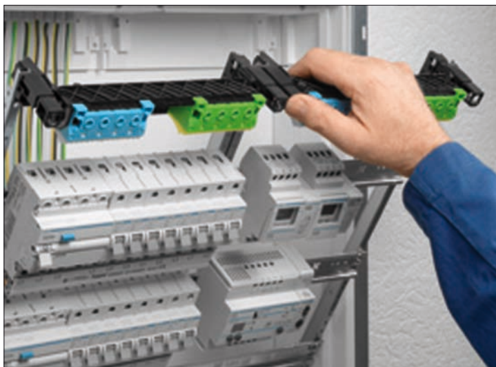
Obr. 3. Přístrojový rošt lze ze skříně po odjištění nosných lišt snadno vyjmout a jeho opětovná montáž se vykonává pouhým nasazením do skříně, neboť je pro tyto účely speciálně upraven
