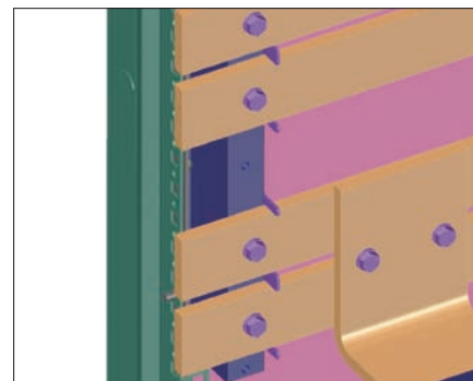
Obr. 9. Detail napojení na hlavní sběrnice vzadu. Připojení je provedeno bez vrtání hlavních sběrnic
