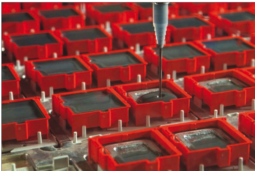
Obr. 1. Zalévání varistoru v modulu DEHNguard
