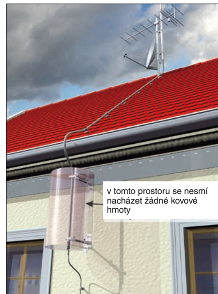
Obr. 8. Napojení vodiče HVI-light na svod 1 m pod úroveň střechy
