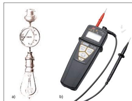
Obr. 5. Zkoušečky napětí a) první zkoušečka, b) současný tester C.A 704
