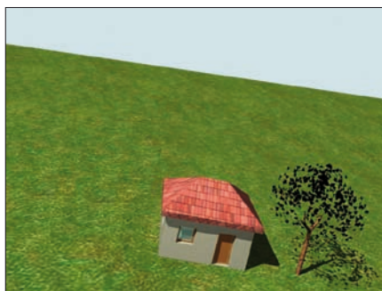
Obr. 10. Po nastavení referenční hodnoty na otáčení pouze okolo příčné elevační osy (svíslá osa kamery) je tento požadavek transformován ( 1/\cos \theta , \theta – elevační úhel kamery) na otáčky azimutálního motoru: výsledkem je obraz domku při dolním okraji zorného pole a navíc natočený
