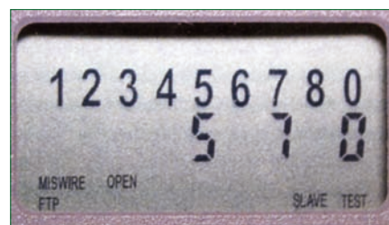
Obr. 5. Test propojení kabelů – chyba (kabel 3: rozpojeno; kabel 1-2: záměna zapojení)
