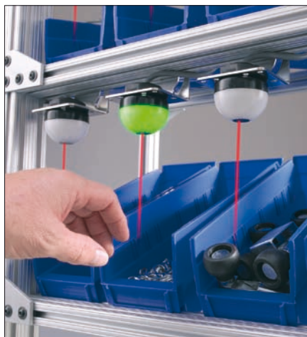
Obr. 1. Indikátory světla pro kontrolu správného postupu při odebrání součástek
